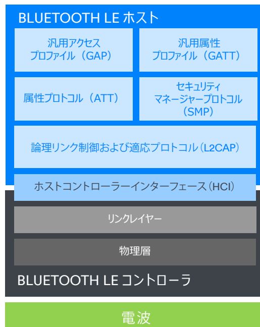
図3a Bluetooth LEおよびGAP/GATT/ATT対応のスタック構成
